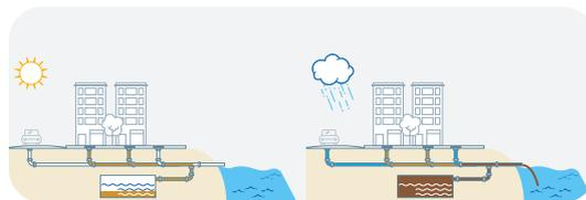
**Abb. 1** - Bei starken Regenfällen kann das Wasservolumen die Kapazität der Abwasserkanalisation übersteigen und wird dann ohne jegliche Behandlung direkt in die natürliche Umwelt abgeleitet.
