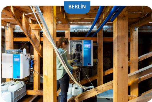
**Abb. 6** - Installation am Flussbad zur Messung der Wasserqualität im Spreekanal.
